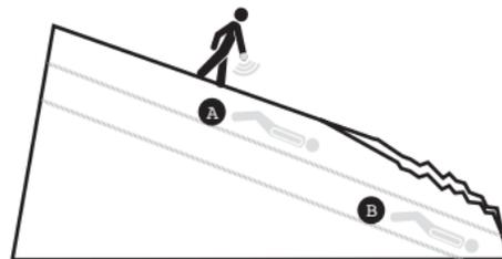
正しい方向に向かっていなければ、アラームが鳴り、「Uターン」アイコンが画面上に表われ、被害者の埋没ゾーンへと正しい方向に進むために方向転換すべきことを示します。
