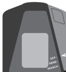
För att slå på enheten trycker du på omkopplaren för OFF/SEND/SEARCH (AV/SKICKA/SÖK) (längst upp till höger på enheten) tills låsknappen låses på plats mekaniskt (den vita pilen ska peka på "SEND" ("SKICKA")).
