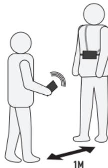
Im GROUP CHECK Modus überprüft das EVO5 zunächst die Sendefrequenz. Wenn diese nicht mit den geltenden Anforderungen übereinstimmt, erscheint die Meldung „no“, was bedeutet, dass das kontrollierte Gerät einen Defekt hat und repariert werden muss. Wenn die Frequenz korrekt ist, wird im Display eine Entfernung angezeigt und Sie können dann die Sendeleistung prüfen:
