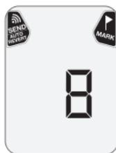
**Varning:** Om en sökning redan pågår för att hitta andra begravda offer, är det viktigt att enheten stannar kvar i sökläget. Om den återgår till sändningsläget, kommer det att påverka sökningen efter andra offer. Se till att du trycker på enhetens markeringsknapp för att stanna kvar i sökläget om du inte har hamnat i eller blivit begravd under en sekundär lavin.
