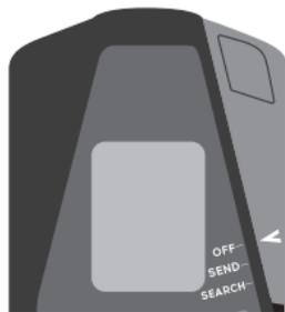
Para encender el dispositivo, presione el interruptor selector (ubicado en la parte superior derecha del dispositivo) hacia abajo, de manera que el botón de bloqueo fije su posición (la flecha blanca debe estar señalando la palabra "ENVIAR").
