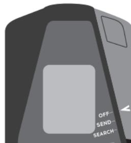
装置の電源を入れるには、(装置の右上側面にある)OFF/SEND/SEARCH選択スイッチを押し下げ、ロック ボタンがスイッチを適所に機械的にロックするのを確認します(白い矢印は「SEND」を指しているはずです)。
