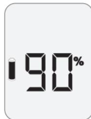
Il dispositivo poi mostra la versione del software installata e il livello di batteria rimanente. Consigliamo di cambiare la batteria non appena il livello di carica è inferiore al 50%. Si può controllare il livello della batteria in ogni momento premendo sul tasto di marcatura in modalità trasmissione.
