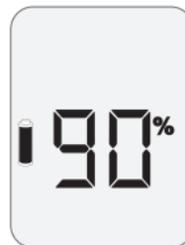
Danach zeigt das Gerät die installierte Software-Version und die verbleibende Batteriekapazität an. Wir empfehlen die Batterie auszutauschen, sobald die angezeigte Kapazität weniger als 50 % beträgt. Im Sendemodus können Sie die verbleibende Batteriekapazität mit einem langen Druck auf die Markierungstaste jederzeit kontrollieren.
