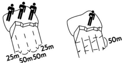
Es ist wichtig, dass Sie Ihr LVS-Gerät auf die Lawine gerichtet, parallel zum Hang halten. Achten Sie auf die ersten Signale und suchen Sie das Lawinenfeld gleichzeitig mit den Augen nach äußeren Anzeichen ab (Skistöcke, Skier, Kleidung usw.). Bei Empfang des ersten Signals erscheint im Display ein Verschütteten-Symbol.
