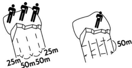
トランシーバーを斜面と平行に雪崩の方に向けることが重要です。視覚的な手掛かり(ストック、スキー、衣服)にも注意しながら、信号の最初の兆候を注意深く聞きます。信号が受信されるとすぐに、被害者アイコンが画面に表示されます。
