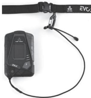
Lassen Sie das EV05 während der Tour in einer Hosentasche mit geschlossenem Reißverschluss. Der Reißverschluss-Schieber muss bis ganz nach oben gezogen sein und darf nur Platz für die Sicherungsleine lassen. Passen Sie den Riemen an, legen Sie ihn um Ihre Taille und schließen Sie die Schnalle.
