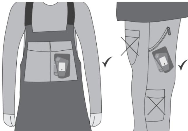
Se till att du inte lägger något annat i fickan där du har din EV05 lavin-transceiver. Lägg inte ner en mobiltelefon i samma ficka och följ alltid de avståndsregler som anges i punkt 5, "STÖRNINGAR".
