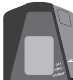
For å slå på enheten trykker du AV/SEND/SØK valgbryteren (plassert øverst på høyre side av enheten) ned til låseknappen mekanisk låser seg på plass (den hvite pilen skal peke på "SEND").
