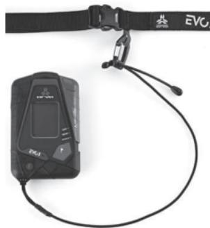
Förvara EV05 i en ficka med dragkedja under hela skidturen. Dragkedjan ska vara helt stängd förutom ett mellanrum som är stort nog för att snodden ska gå igenom. Justera bältet runt midjan och spänn fast det.
