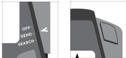
Il selettore è correttamente bloccato quando, in modalità di trasmissione, il pulsante di blocco si attiva, lo si sente scattare in posizione e non è più possibile spingerlo verso il basso.
