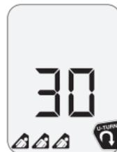
Si fueran varias las personas enterradas o hubiera interferencias en la zona, el dispositivo podría llegar a sufrir una sobrecarga de datos. En tal caso, deberá alejarse de la zona específica y, a continuación, volver a la misma dirigiéndose a una dirección diferente.
