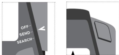
Der Schieberegler ist ordnungsgemäß verriegelt, wenn die Verriegelungstaste im Sendemodus herausragt und Sie ein Klickgeräusch gehört haben, welches Sie darüber informiert, dass sich der Schieberegler in der Sendeposition befindet.
