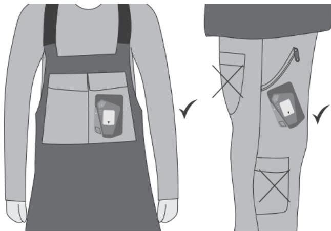
EVO5雪崩トランシーバーを入れるポケットには他の物を入れないでください。携帯電話は同じポケットに入れず、「5.電波干渉」の項に記載の距離ガイドラインに従ってください。
