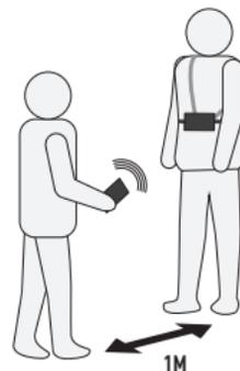
Nella modalità GROUP CHECK l'EVO5 inizia con l'analizzare la frequenza trasmessa. Se la frequenza non rispetta gli standard attuali, apparirà un messaggio "no" indicando che il dispositivo è risultato difettoso durante il controllo e deve essere inviato al servizio clienti. Se la frequenza rispetta gli standard, verrà mostrata la lettura della distanza sullo schermo e si può procedere con il controllo della potenza di trasmissione :
