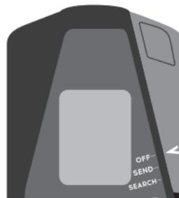
Käynnistä laite painamalla OFF/LÄHETÄ/HAKU-valitsinta (sijaitsee laitteen oikealla puolella ylhäällä) alas, kunnes lukituspainike lukittuu mekaanisesti paikalleen (valkoinen nuoli osoittaa "LÄHETÄ"). Valitsin on oikein lukittu, kun lukituspainike on siirto-tilassa tulee esiin ja kuulet sen naksahdavan paikalleen etkä pysty painamaan sitä.
