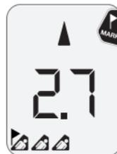
Jos uhreja on monta, astu heti yhden uhrin merkinnän jälkeen 1 metrin päähän, jotta laite pystyy nopeasti etsimään seuraavaa uhria. Uhrin merkinnän yhteydessä uhrin kuvakkeen viereen ilmestyy lippu.
